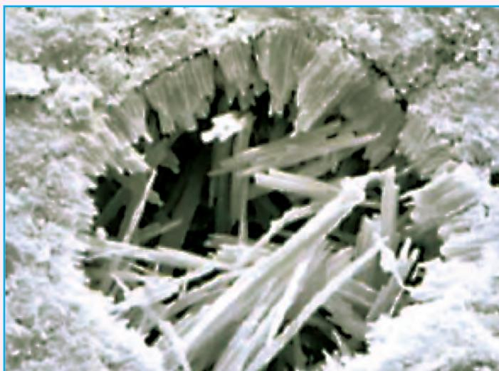
**Рисунок 1.** Пора, заполненная кристаллами этtringита
